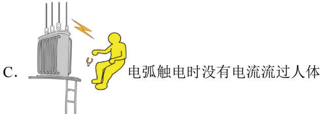
高压设备容易产生电弧触电
