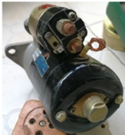
拆卸电磁开关至电动机间的供电缆线
