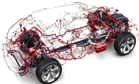
图 16：汽车线束结构爆炸图（后侧视角）
