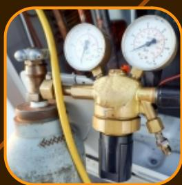
使用储气罐时，应先打开储气罐的出气阀门，再打开使用设备的进气阀门，确保气流稳定、无泄漏。
