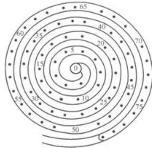
图 5-4 聚合物可模塑性测定实验模具
