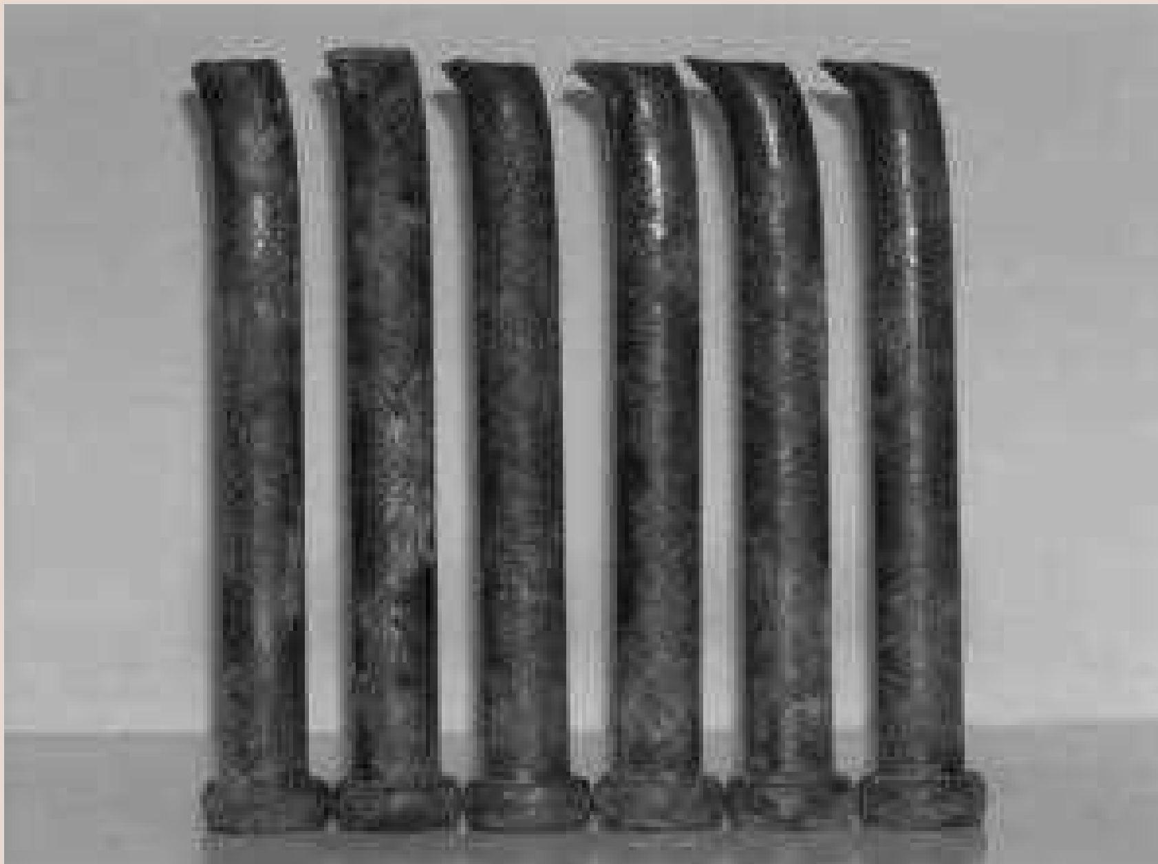
栓钉破坏后的变形状况
