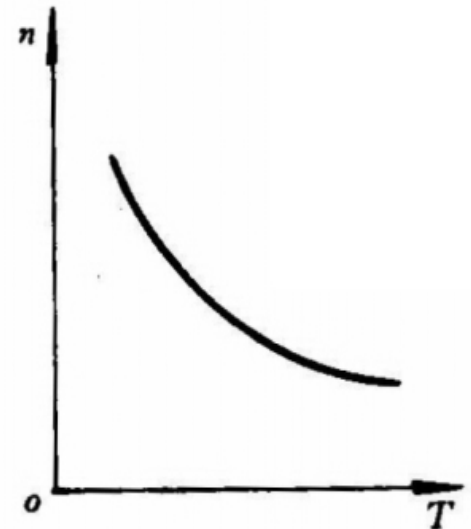
图 2.7 恒功率型机械特性
