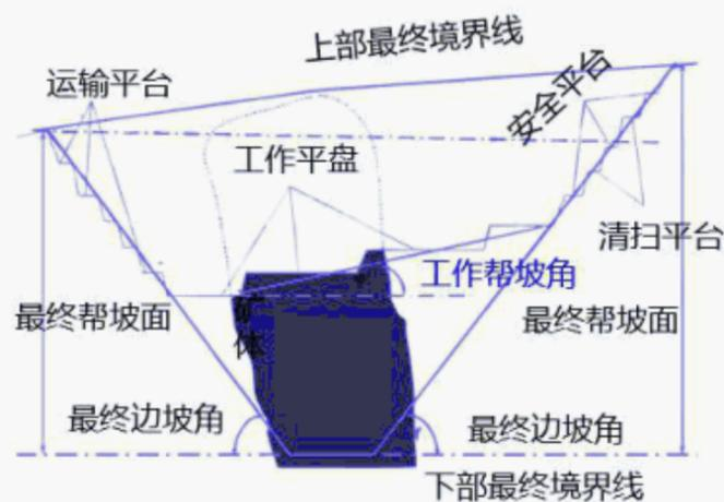
台阶有坡顶面、坡底面和台阶坡面组成
