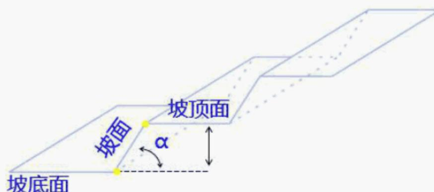
台阶高度应不小于挖掘机推压轴高度的 2/3 (以便满斗)。台阶高度应小于挖掘机最大挖掘高度 (为
