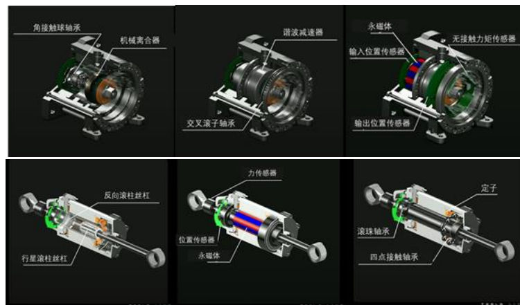
图 29：特斯拉人形机器人采用的旋转和线性执行器示意图
