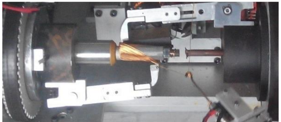
图 22：一次成型绕线过程
