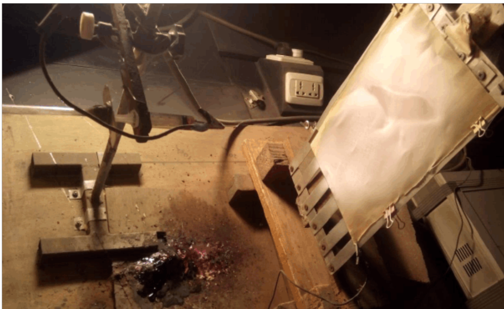
图2-2 本次实验制备碳纤维的静电纺丝装置
