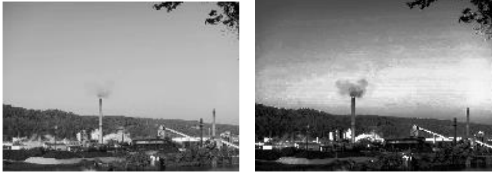
图 2-4 HSV 空间灰度均衡化效果图
