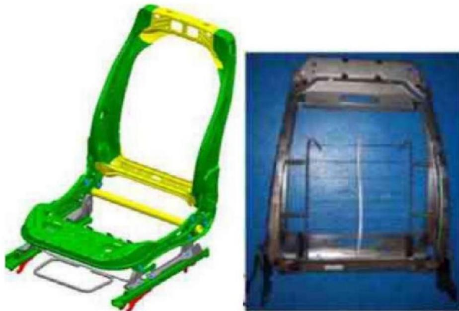
图1.7 座椅骨架及其悬挂装置
