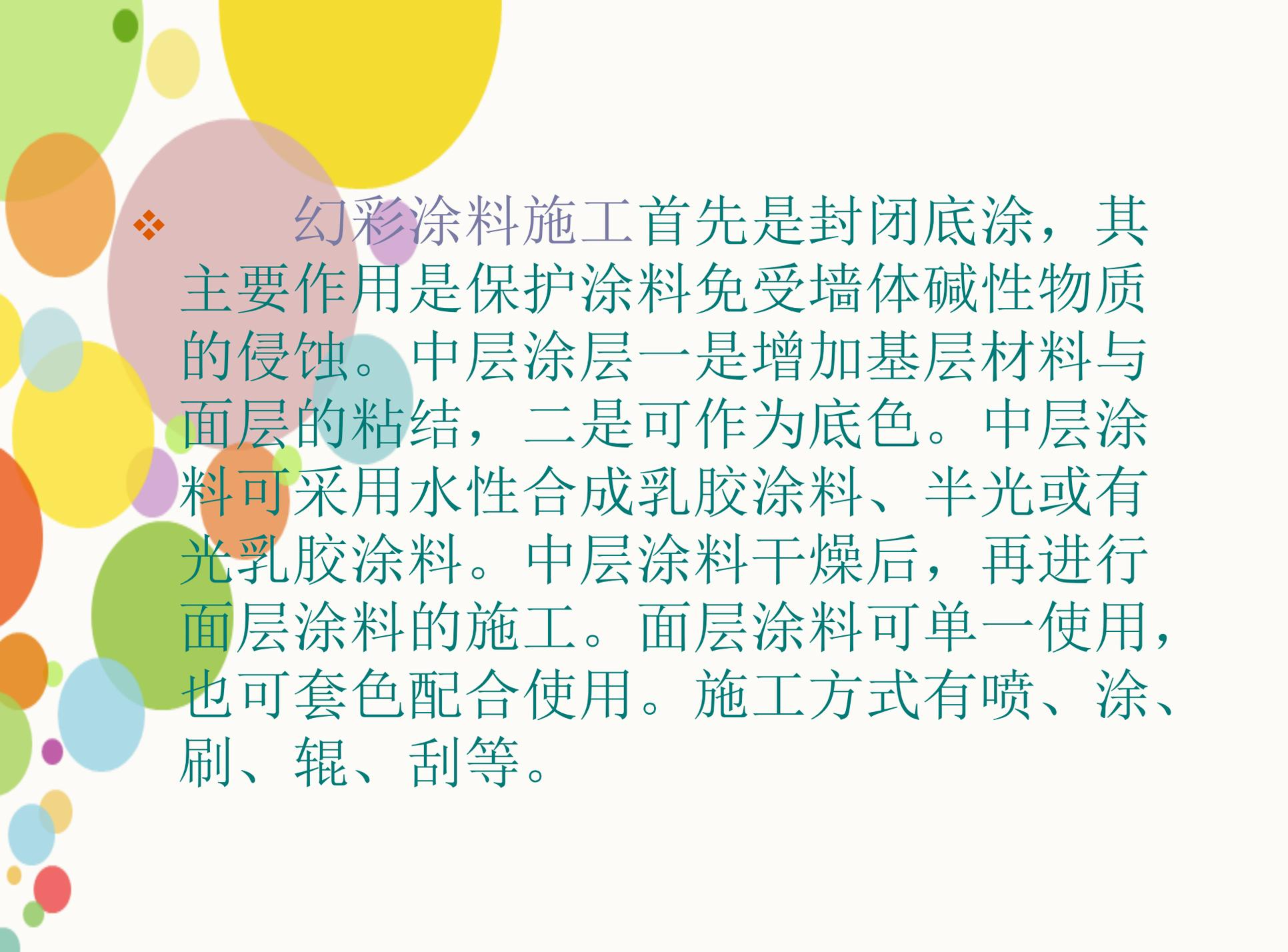
❖ 幻彩涂料施工首先是封闭底涂，其主要作用是保护涂料免受墙体碱性物质的侵蚀。中层涂层一是增加基层材料与面层的粘结，二是可作为底色。中层涂料可采用水性合成乳胶涂料、半光或有光乳胶涂料。中层涂料干燥后，再进行面层涂料的施工。面层涂料可单一使用，也可套色配合使用。施工方式有喷、涂、刷、辊、刮等。
