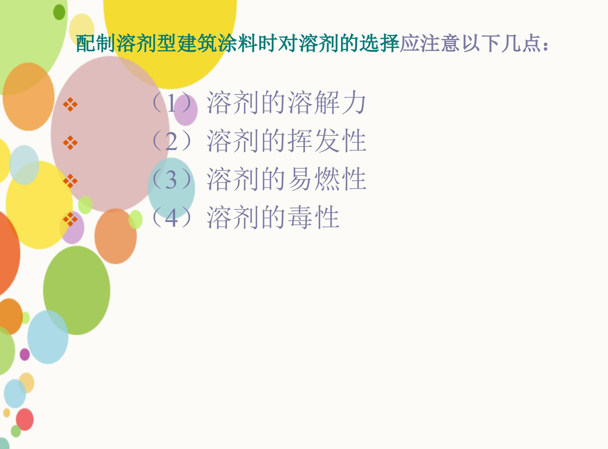
配制溶剂型建筑涂料时对溶剂的选择应注意以下几点：
