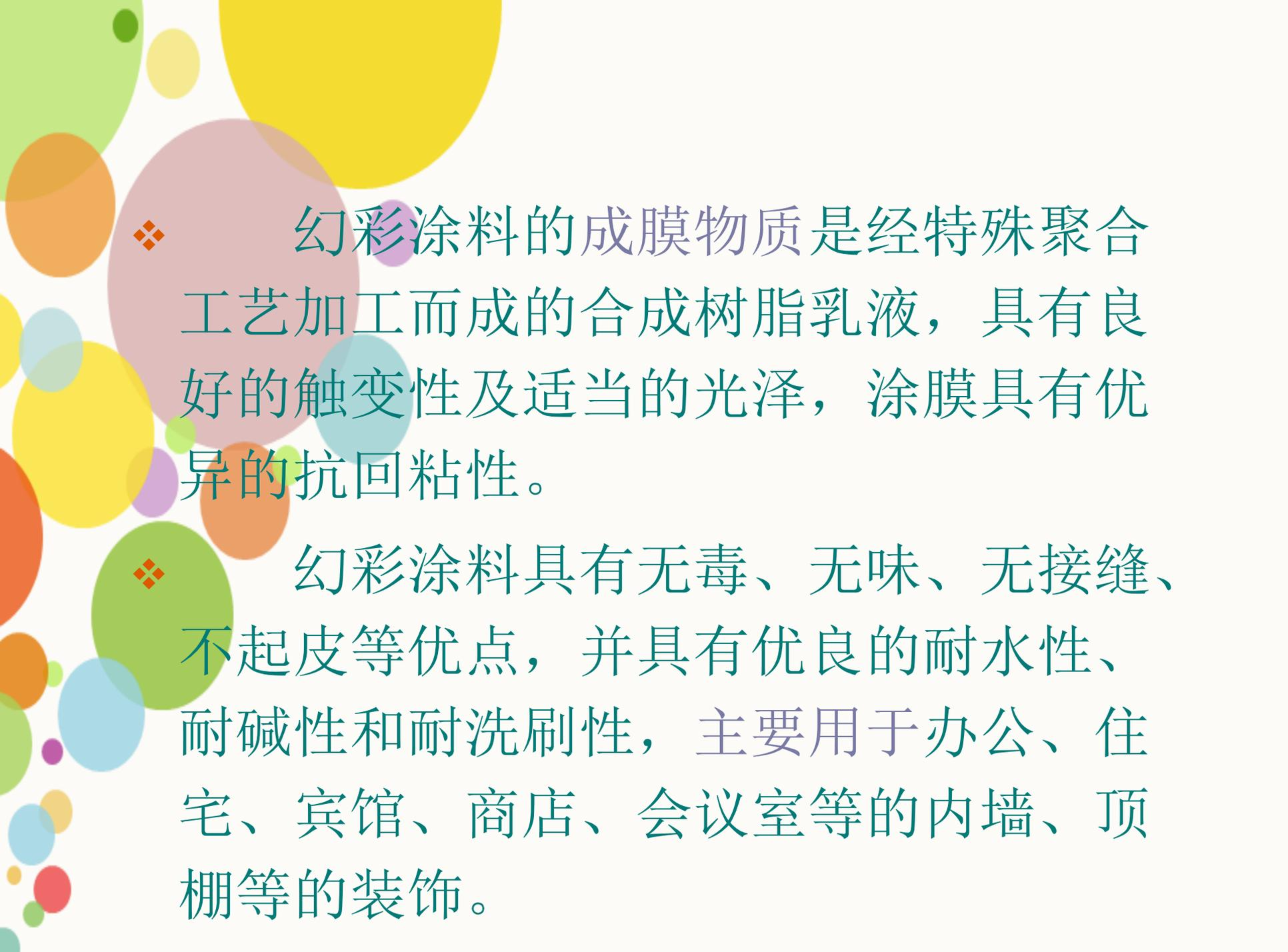
❖ 幻彩涂料的成膜物质是经特殊聚合工艺加工而成的合成树脂乳液，具有良好的触变性及适当的光泽，涂膜具有优异的抗回粘性。
