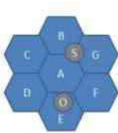
图4-1 频率复用示意图
