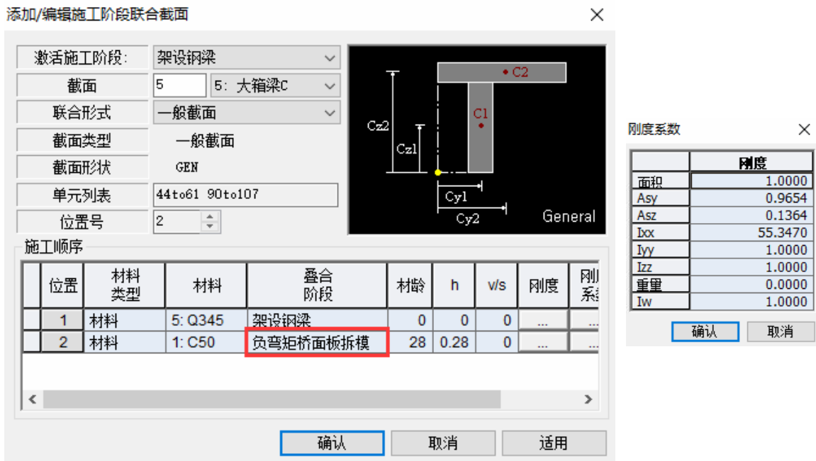
图 17 桥面板第 2 次安装导出为施工联合截面的刚度叠合
