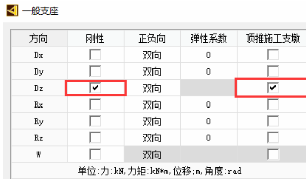
图 32 桥博支座勾选顶推施工支墩
