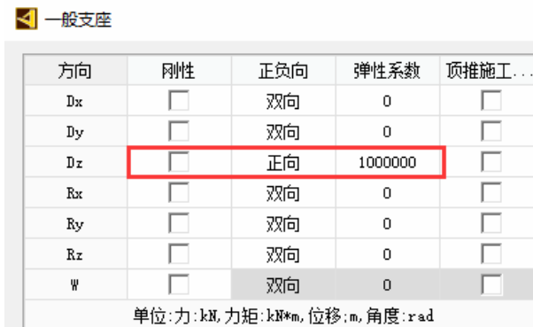
图 34 桥博支座勾选顶推施工支墩
