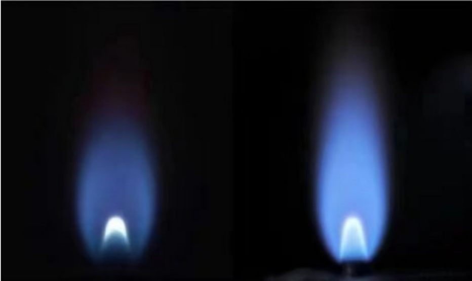
空间站上甲烷燃烧图像（左）与地面同工况甲烷燃烧图像（右）
