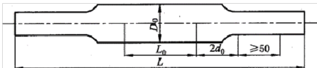
图 6—2—11 全截面管材试样塞头形状图
