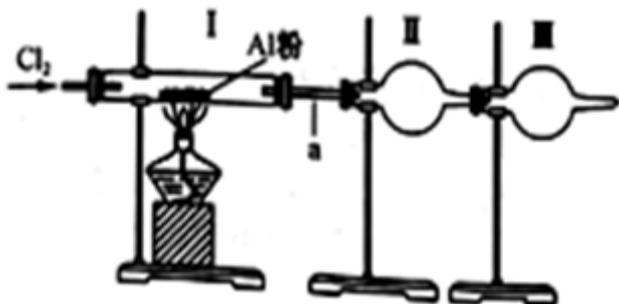
①氯气中含的水蒸气和氯化氢可通过盛有苛性钠的干燥管除去 ②装置 I 中充满黄绿色气体后，再加热盛有铝粉的硬质玻璃管 ③装置 II 是收集装置，用于收集氯化铝 ④装置 III 可盛放碱石灰也可盛放无水氯化钙，二者的作用相同 ⑤a 处使用较粗的导气管实验时更安全
