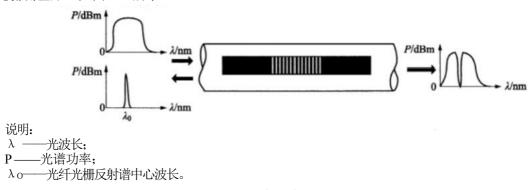
图A.1 光纤光栅测温原理图
