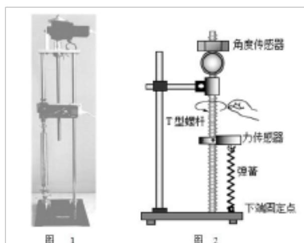
当角度传感器顶端转盘带动“T”形螺杆转动时，力传感器会随着“T”形螺杆旋转而上下平移，弹簧长度也随之发生变化。
