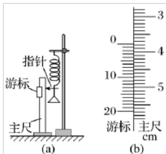
现要测量图(a)中弹簧的劲度系数. 当托盘内没有砝码时, 移动游标, 使其零刻度线对准指针, 此时标尺读数为 $1.950\text{ cm}$ ; 当托盘内放有质量为 $0.100\text{ kg}$ 的砝码时, 移动游标, 再次使其零刻度线对准指针, 标尺示数如图(b)所示, 其读数为\_\_\_\_\_cm. 当地的重力加速度大小为 $9.80\text{ m/s}^2$ , 此弹簧的劲度系数为\_\_\_\_\_N/m(保留3位有效数字).
