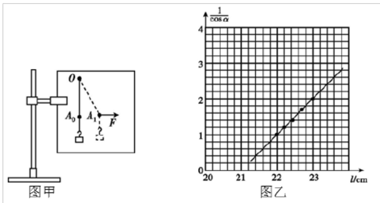
①如图甲所示，将白纸固定在制图板上，橡皮筋一端固定在 $O$ 点，另一端 $A$ 系一小段轻绳(带绳结)，将制图板竖直固定在铁架台上。
