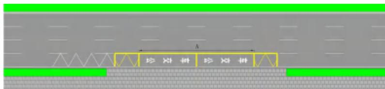
图76 路边式停靠站标线设置示例
