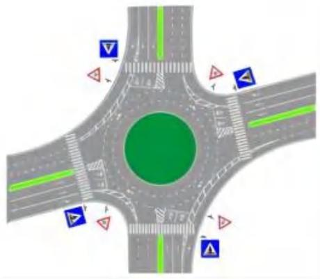
图25 环形交叉口减速让行线设置示例
