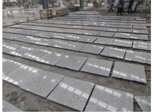
出厂前进行石材排版验收
