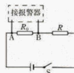
(1) 当 AB 间电压刚好达到报警电压时，R 两端的电压是多少，通过  $R_0$  电流为多少？
