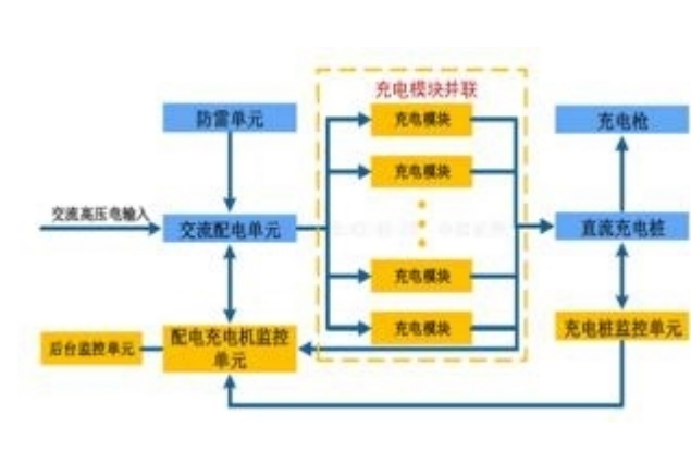
图 8：直流充电桩内部单元结构图
