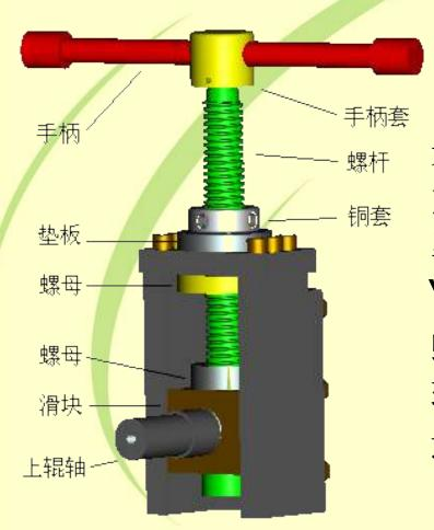
板材在卷制过程中, 曲率 的控制是通过调整上辊的压下量 来实现的, 压下量可通过标尺任 意调整,实现了一定范围内的曲 率半径的卷曲。上辊的压下采用 "螺母固定,螺杆转动并移动"的 螺旋传动方式,并通过滑块使上 辊轴与螺杆保持相对静止, 从而 达到上辊轴与螺杆同步升降的目 的。
