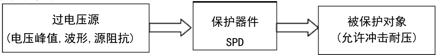
图 2.14-3 采用 SPD 的过电压保护系统的三个基本环节
