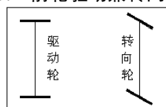
图 3.3 后轮驱动，前轮转向结构
