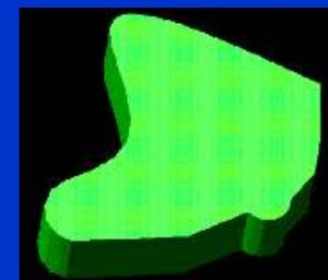
由直线、圆弧、样条曲线、椭圆弧、多段线形成的面域
