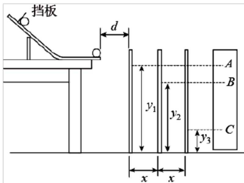
(1) 在一块平木板上钉上复写纸和白纸，将其竖直立于斜槽轨道末端槽口前，木板与槽口之间有一段初始距离  $d$ ，并保持板面与轨道末端的水平段垂直。
