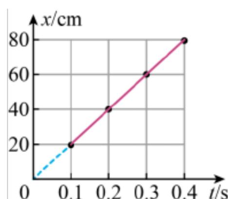
由图像可以看出，小球水平方向的位移—时间图线为一条经过原点的直线，说明位移随时间均匀变化，即影子的运动为匀速直线运动，也就说明小球在水平方向的运动为匀速直线运动。
