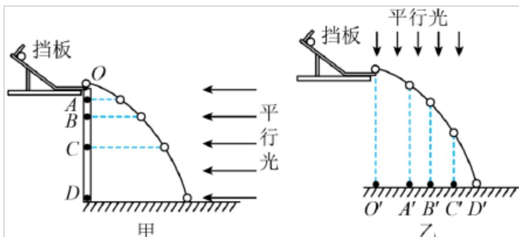
(1) 如图甲所示， $OD$  为一竖直木板，小球从斜槽上挡板处由静止开始运动，离开  $O$  点后做平抛运动，右侧用一束平行光照射小球，小球在运动过程中便在木板上留下影子。如图甲是用频闪照相机拍摄的小球在运动过程中的位置以及在木板上留下的影子的位置，如图中  $A$ 、 $B$ 、 $C$ 、 $D$  点。现测得各点到  $O$  点的距离分别为  $5.0\text{cm}$ 、 $19.8\text{cm}$ 、 $44.0\text{cm}$ 、 $78.6\text{cm}$ 。试根据影子的运动情况讨论小球在竖直方向上的运动情况。（已知照相机的闪光频率为  $10\text{Hz}$ ）
