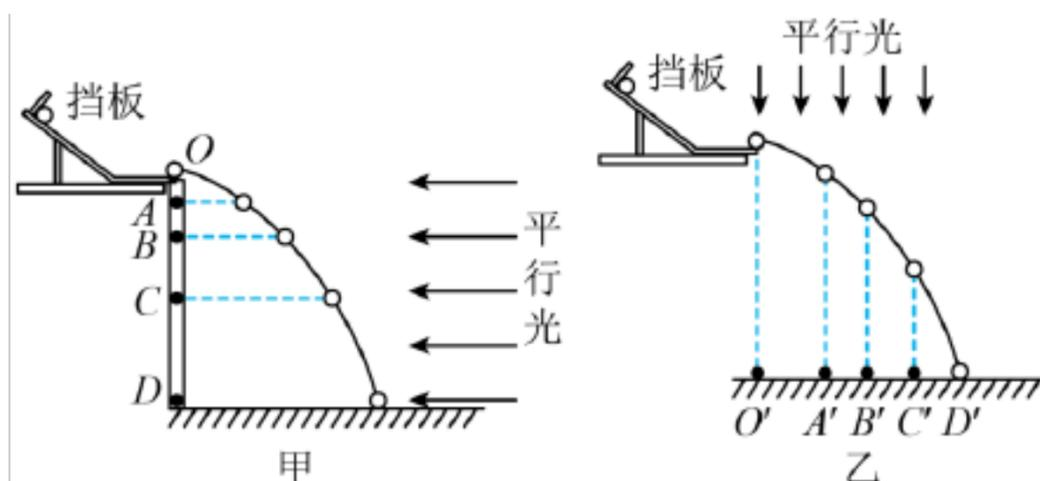
(1) 如图甲所示， $OD$  为一竖直木板，小球从斜槽上挡板处由静止开始运动，离开  $O$  点后做平抛运动，右侧用一束平行光照射小球，小球在运动过程中便在木板上留下影子。如图甲是用频闪照相机拍摄的小球在运动过程中的位置以及在木板上留下的影子的位置，如图中  $A$ 、 $B$ 、 $C$ 、 $D$  点。现测得各点到  $O$  点的距离分别为  $5.0\text{cm}$ 、 $19.8\text{cm}$ 、 $44.0\text{cm}$ 、 $78.6\text{cm}$ 。试根据影子的运动情况讨论小球在竖直方向上的运动情况。（已知照相机的闪光频率为  $10\text{Hz}$ ）
