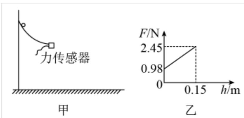
(1)让小球从轨道的不同高度处由静止下滑，记录每次释放时小球距离轨道末端的高度  $h$  和小球到达轨道末端时力传感器的示数，作出  $F-h$  图像如图乙所示，则小球的质量  $m=$ \_\_\_\_\_kg，圆弧轨道的半径  $R=$ \_\_\_\_\_m。
