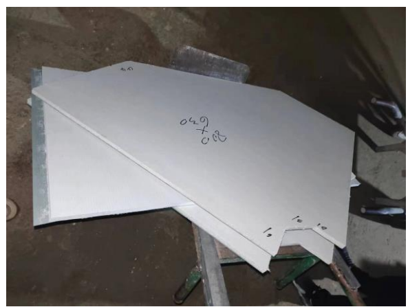
图 5.2.2-4 下料完成移交至组装班组
