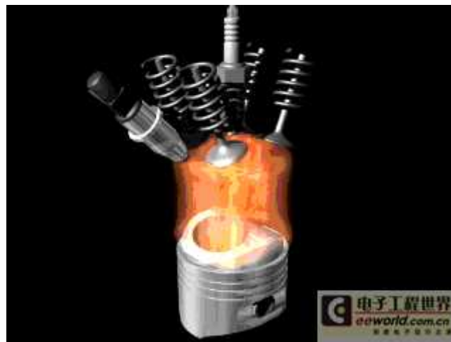
缸内直喷发动机气缸内的工作状态
