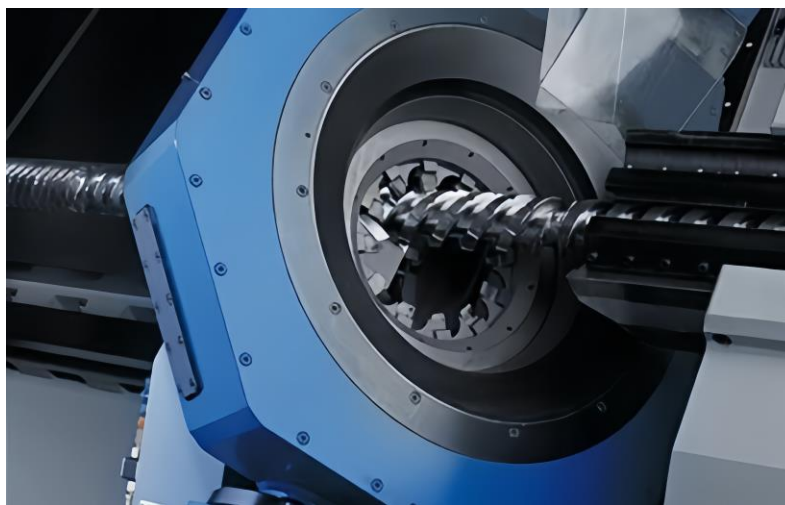
图：丝杠的旋风铣制作工艺
