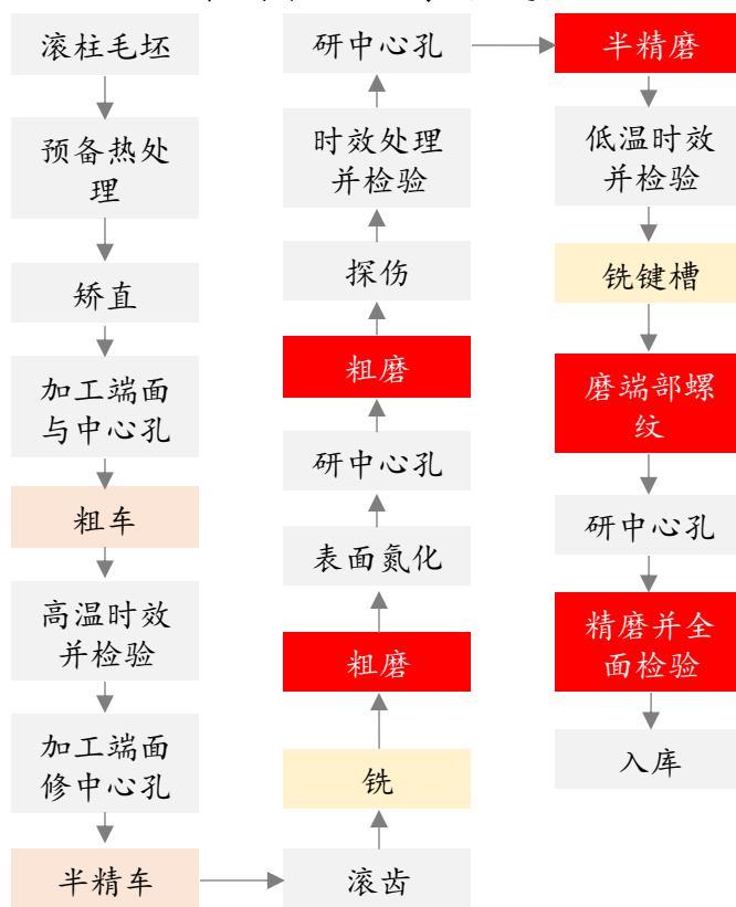
图：滚柱加工工序（24道）
