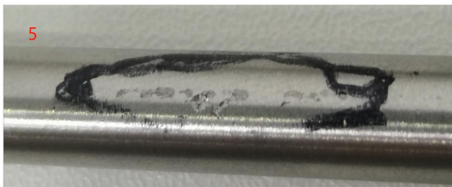
图 9: \Phi 12\text{mm} 圆棒材缺陷实物图
