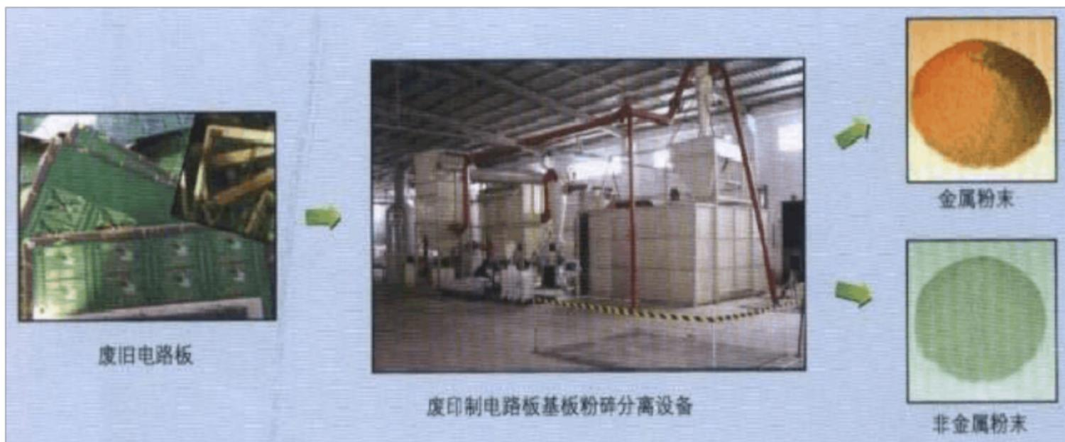
图 5-4 废印制电路板基板粉碎设备示意图
