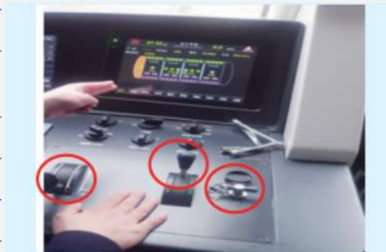
图 2-7 司机控制器（主控钥匙、方向手柄、主控手柄）
