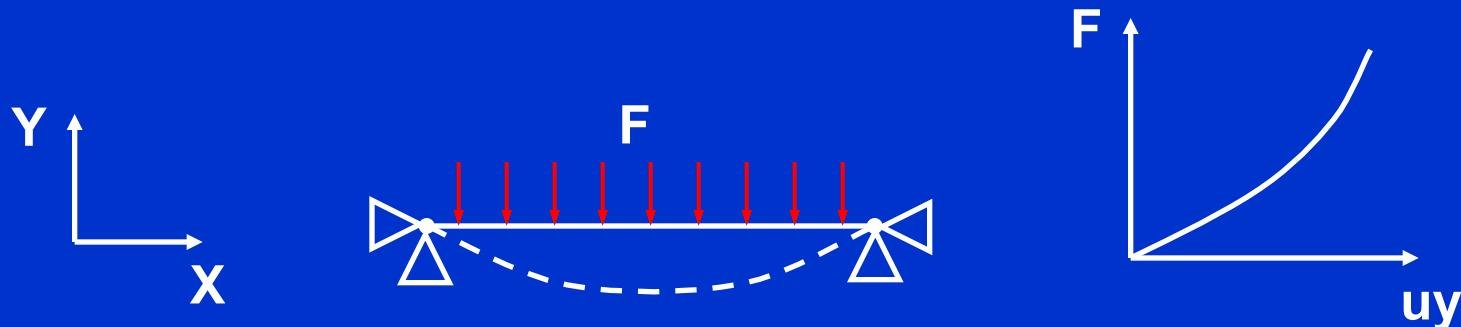
随着垂直挠度的增加 ( $u_y$ ), 较大的膜应力 ( $S_x$ ) 导致刚化效应.
