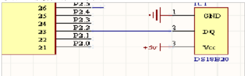
图 3-2 DS1820 与单片机的接口电路设计图
