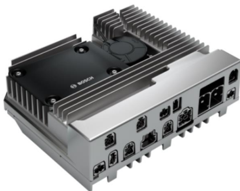
图 16 博世使信息娱乐与 ADAS 功能在同一个车载计算机中运行
