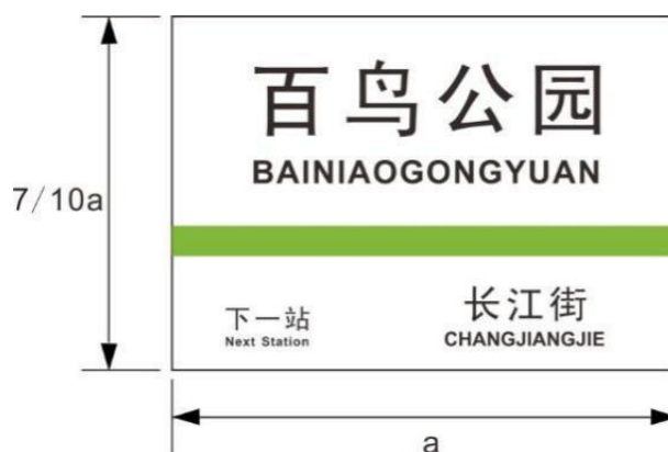
图 2 悬挂式导向标志外形尺寸示例
