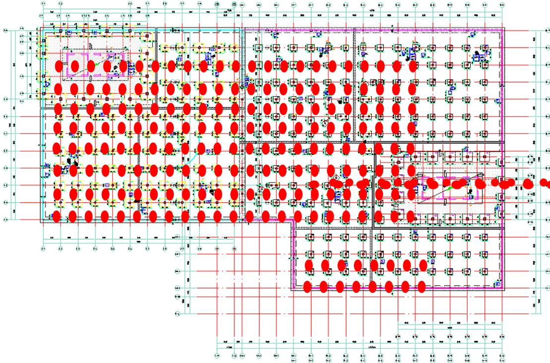
图 6.4.6-2 筏板测温布置点示意图
