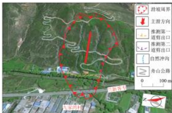
图1 滑坡地理位置及滑动前地貌影像图(2018年11月)
