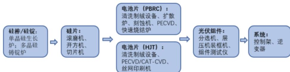
A. 硅片制造。首先原料硅砂（二氧化硅）经纯化过程冶炼出太阳能发电级的多晶硅，再将多晶硅材料加工成硅晶片；
