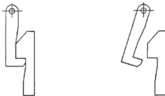
图2.9 机械式压缩弹簧机构工作原理示意图
