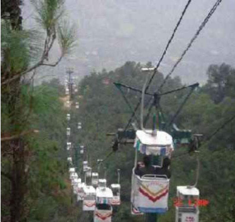
图1-3单线循环吊篮式客运索道
