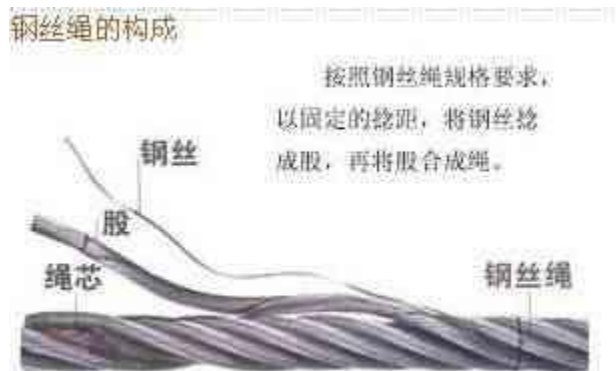
图2-1 钢丝绳的构成
