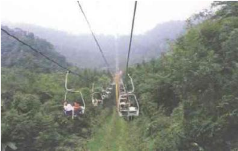
图1-1单线循环吊椅式客运索道
