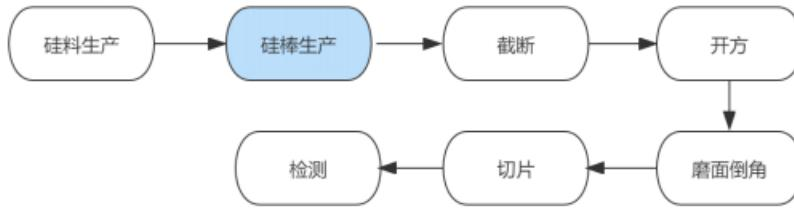
在硅片制造过程中，单晶硅生长炉和切片机是核心设备。其中单晶硅生长炉尽管型式不同，但总体由炉体、电气部分、热系统、水冷系统、真空系统和氩气供给装置六部分组成。其中炉体由上炉室、下炉室、副炉室、旋转阀、炉底板、炉盖六大主要部件构成，是光伏单晶硅生长炉核心部件之一。一般来说，炉体大件、炉体平台等部分零部件一般采取向合格供应商外协定制加工的方式，零部件制造商根据下游晶体生长设备制造商提供的技术资料和规格要求进行定制化生产。
