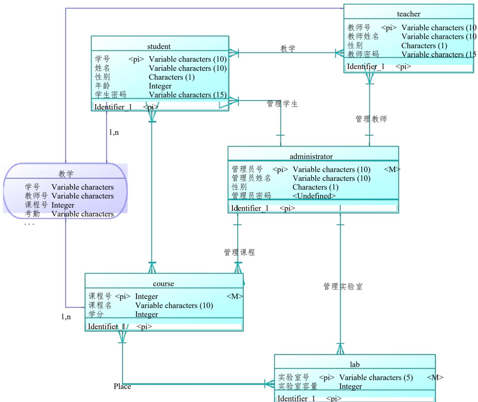
图 实验选课系统的概念模型图
