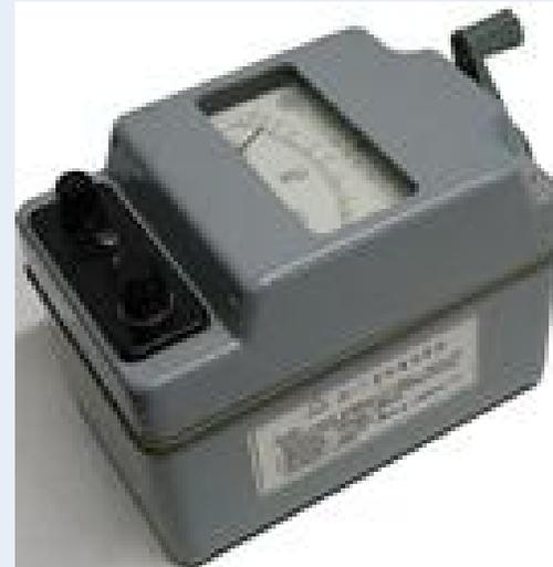
绝缘电阻表的接线端钮有3个，分别标有“G（屏）”、“L（线）”、“E（地）”。被测的电阻接在L和E之间，G端的作用是为了消除表壳表面L、E两端间的漏电和被测绝缘物表面漏电的影响。在进行一般测量时，把被测绝缘物接在L、E之间即可。但测量表面有不干净或潮湿的对象时，为了准确地测出绝缘材料内部的绝缘电阻，就必须使用G端。
