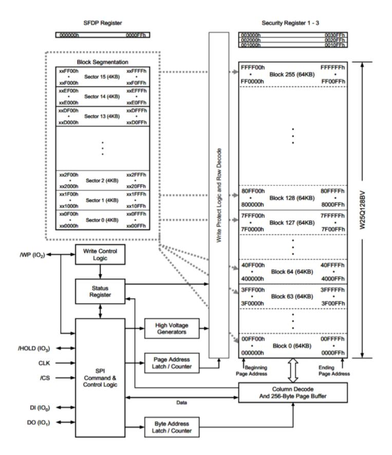
更多详细的内容请阅读 W25Q128BV 的芯片手册。由于本文要进行 4 线 SPI 的操作,但 QSPI Flash 默认的操作模式是标准单线 SPI 模式,所以在每次进行 4 线 SPI 操作的时候一定要先把状态寄存器 2 的 QE 位(倒数第 2 位)置 1,然后才能进行 QSPI 操作。
