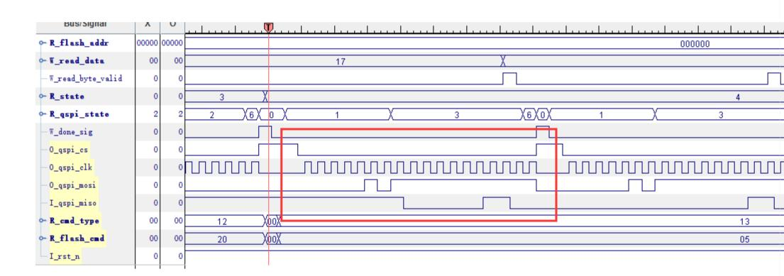
由于在擦除操作和写操作(Page Program)操作指令发送完毕以后,芯片内部会自己执行相关的操作并把状态寄存器 1 中的最低位 Busy 位拉高,状态寄存器 1 的各位如下:
