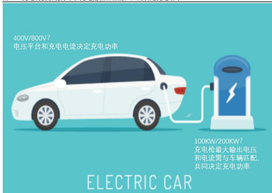
图 1：充电需要新能源车和充电枪相互匹配，共同决定充电功率
