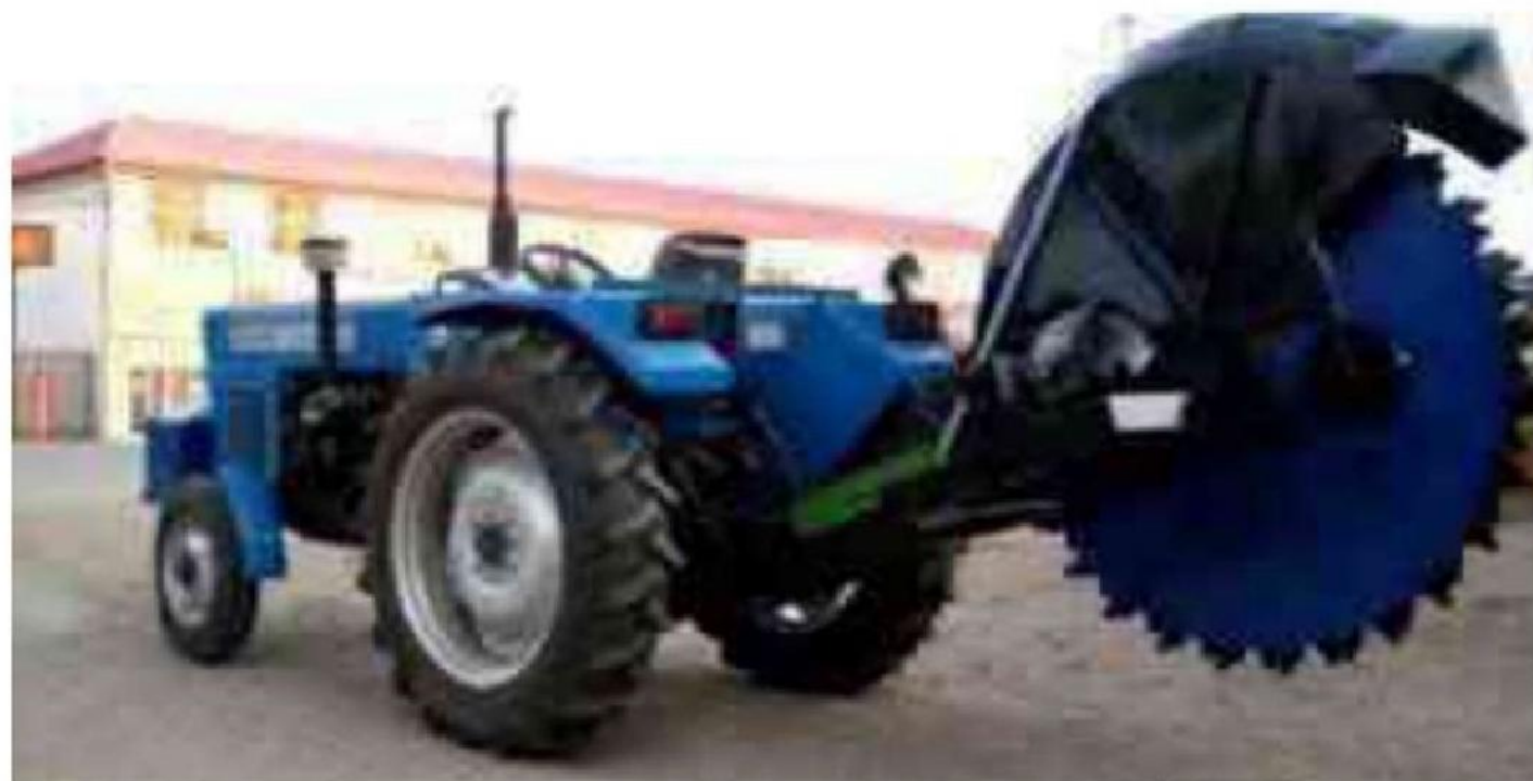
图 3 河南凤翔 TD50 轮盘式开沟机
